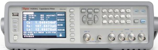
TH2638B 是用於頻率 100Hz, 120Hz, 1kHz, 10kHz 和測試信號可以 (0.1V~1V) 對陶瓷電容(MLCC)做出評估。
