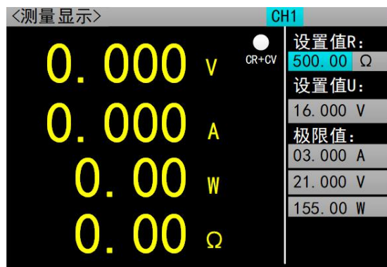
图 2.6.5 定电阻转定电压测量模式
