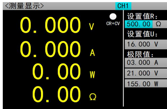
图 2.6.5 定电流转定电压测量模式
