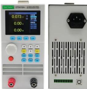
ET5400A+系列單/雙通道可程式直流電子負載具有150V、500V電壓範圍，具有超高功率密度。業界唯一將400W直流電子負載做到如此小的體積。支援4種CV/CC/CR/CP基本工作模式，以及2種CC+CV / CR+CV複合工作模式。具有過電流、過功率、過溫警告保護功能，過壓、反接警告功能，可提供完備保護。標配USB通訊方式，RS232、RS485可選配(二擇一)。1mV/1mA 的解析度，性能優越，可廣泛運用於充電器，開關電源，線性電源，各類電池等行業的生產線測試，研究機構等研發領域。
