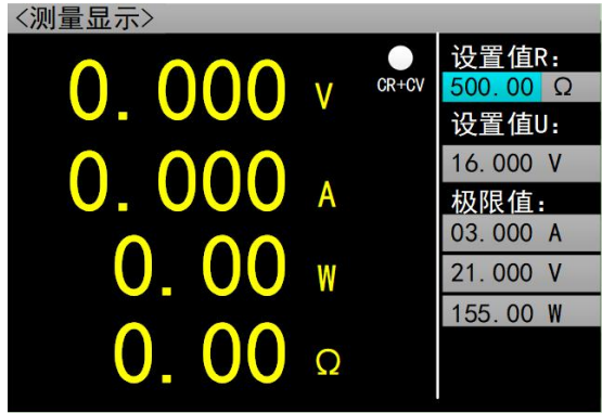
图 2.6.5 定电阻转定电压测量模式
