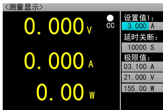
图 2.6.1 定电流测量模式
