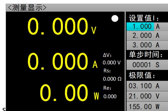
图 2.4 负载效应测试界面图
