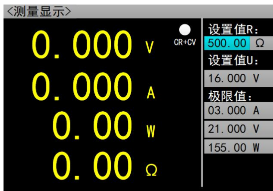
图 2.6.5 定电流转定电压测量模式
