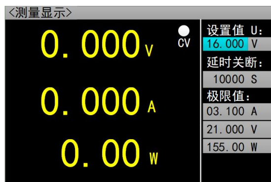
图 2.6.2 定电压测量模式
